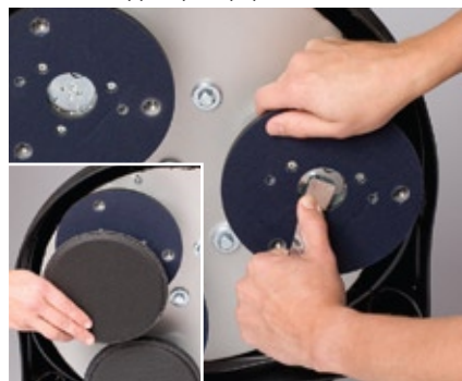
Photo 1 - Support pour papier verre et Foamflex
